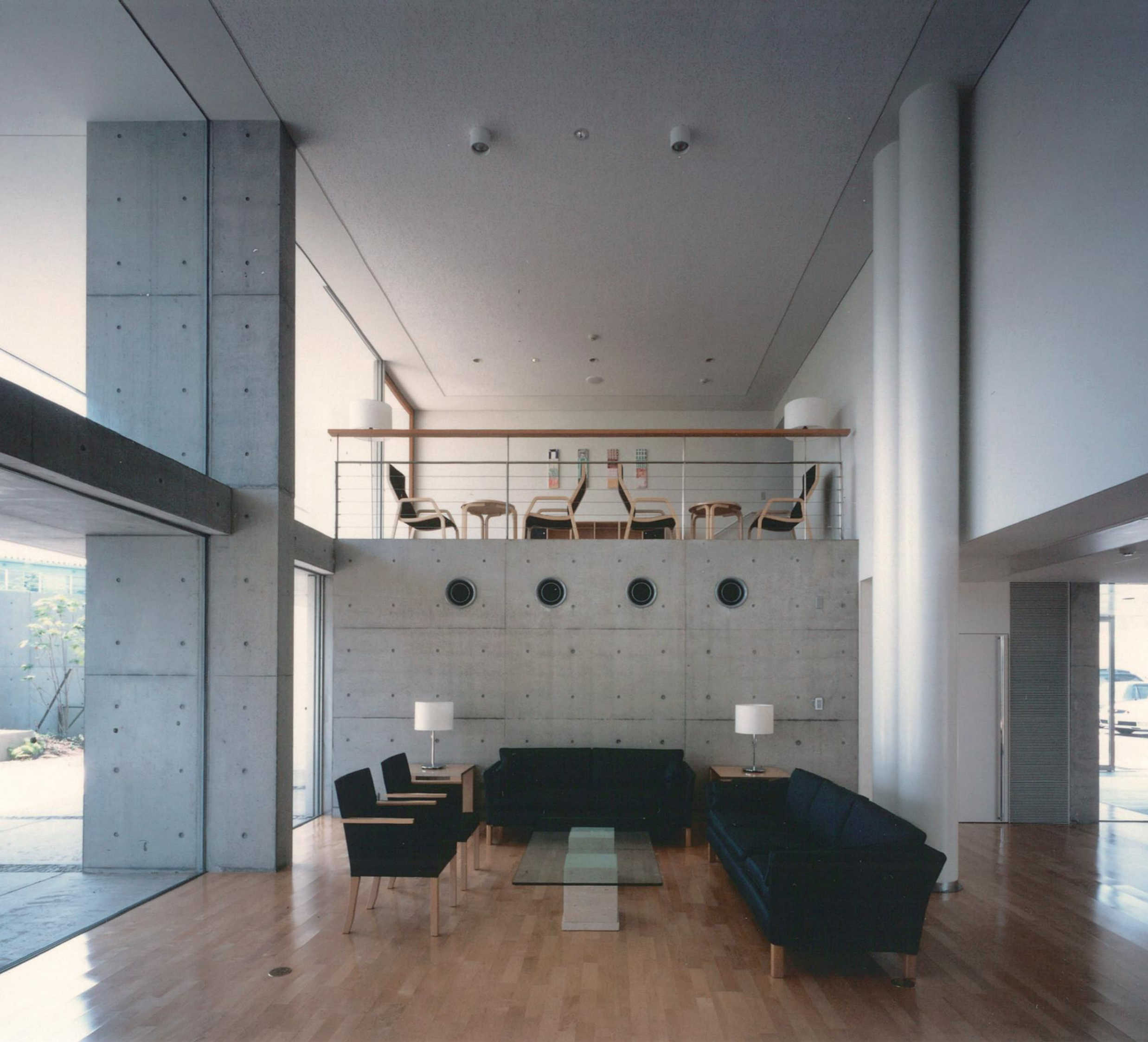
ロビーよりエントランスロビーを見返す。白い壁はコンクリートモルタル補修の上にAEP塗布。
